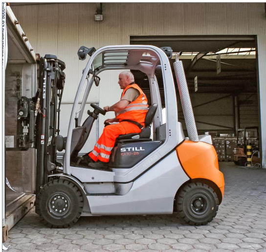
Hier ist das Rückhaltesystem/der Beckengurt ordnungsgemäß angelegt.
